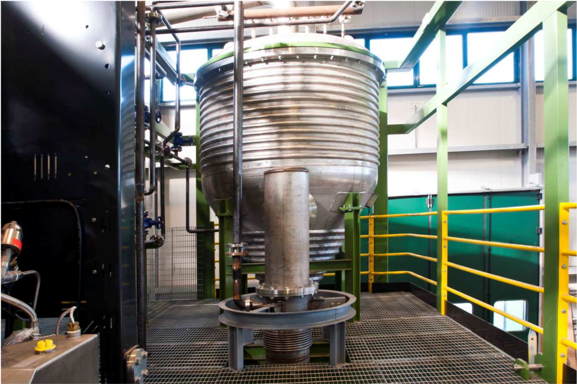
SCAMBIATORE PRIMARIO – FILTRO A MANICHE RISCALDATO
